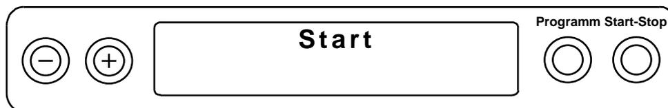
Beim Start des Schnellprogrammes erfolgt zusätzlich die Warnmeldung „Achtung nur unverpackte Instrumente“. Diese Meldung muss durch nochmaliges Drücken der Taste „Start“ quittiert werden.
