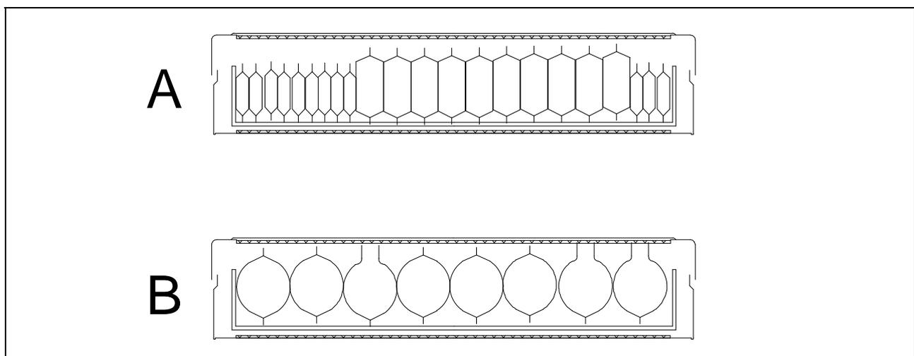
Packweise von "weicher" Sterilisationsverpackung in Sterilisationsbehälter
