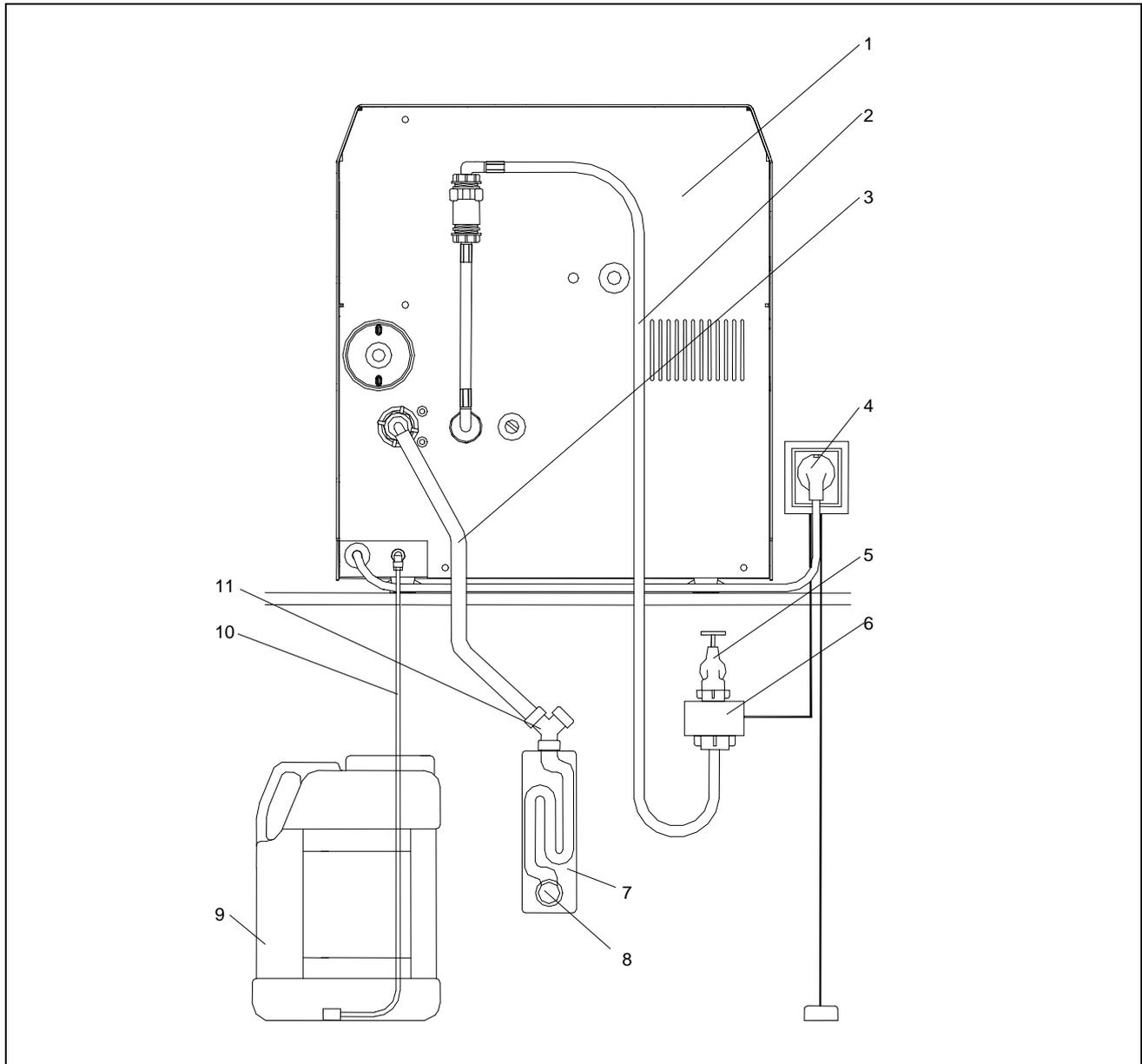
Abb. 3 Installationsbeispiel Vacuklav®24-B mit Vorratsgefäß für aqua dest / aqua dem und Wandabfluss
